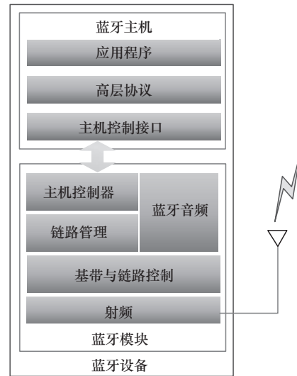
图 3 蓝牙系统构成
